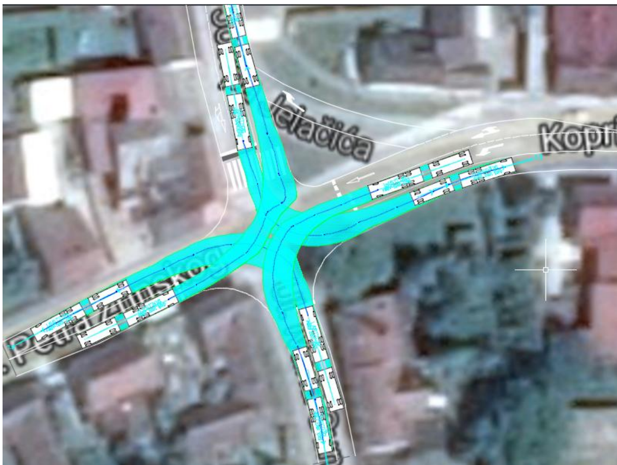
Slika 29. Provjerene trajektorije u programskom alatu AutoTURN za raskrižje Ulice Petra Zrinskog – Koprivničke ulice – Ulice bana Josipa Jelačića – Ulice Ivana Gundulića
