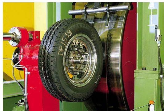
Slika 17. Bubanj za testiranje, [25]
