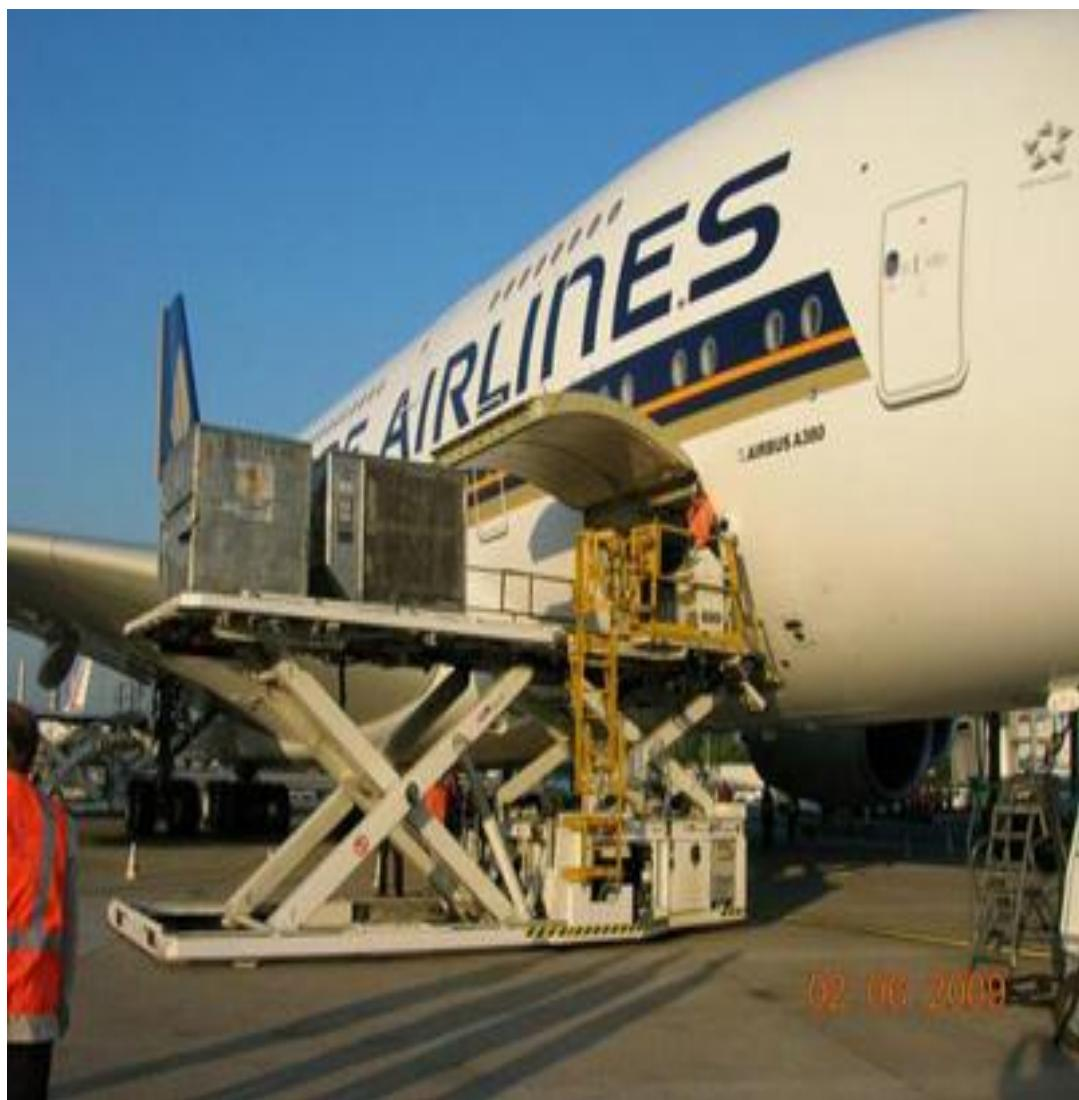
**Slika 8:** Istovar ULD-a pomoću Cargo utovarivača
