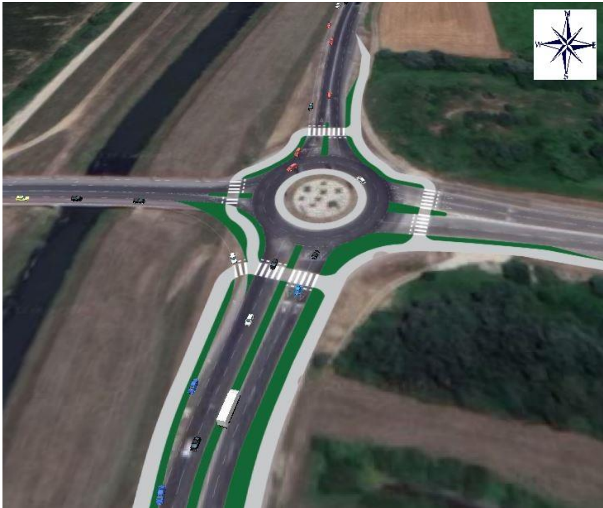
Slika 36. Prikaz simulacije idejnog prometnog rješenja „Raskrižja broj 1“
