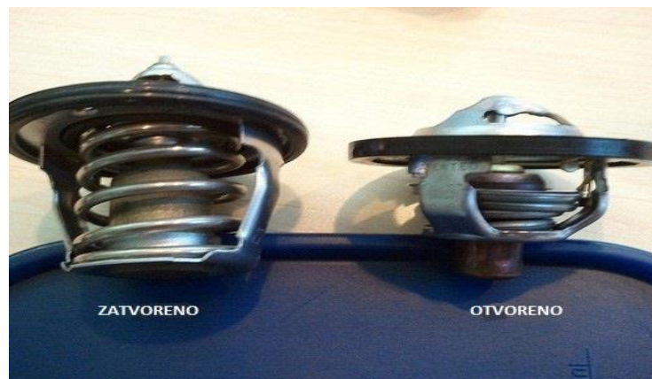
Slika 22. Prikaz zatvorenog (lijevo) i otvorenog (desno) termostata
