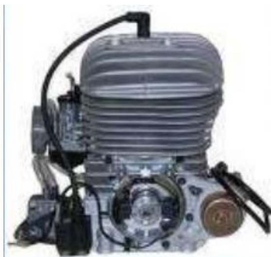
Slika 17. Prikaz motora sa prirodnom cirkulacijom zraka
