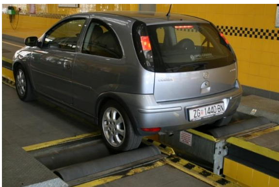
Slika 26. Vozila na valjcima za ispitivanje kočne sile
