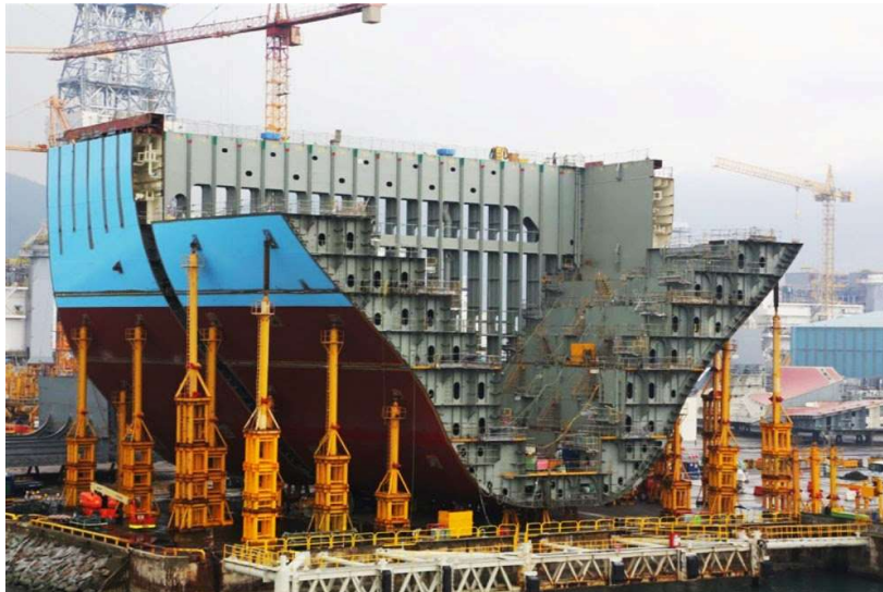
Slika 16. Konstrukcija trupa kontejnerskog broda
