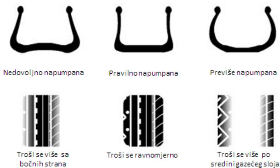
Slika 36: Kako tlak utječe na deformaciju pneumatika
