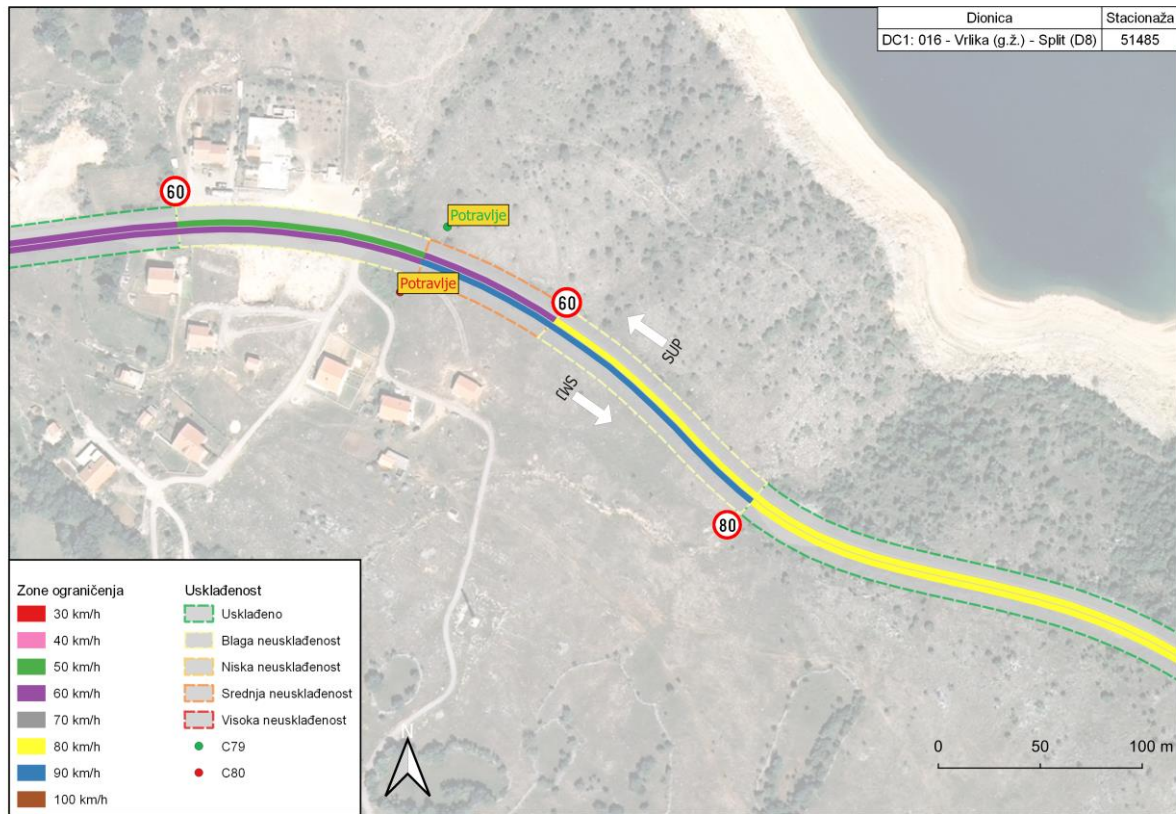
Slika 3. Primjer neusklađenih ograničenja brzine - lokacija 3
