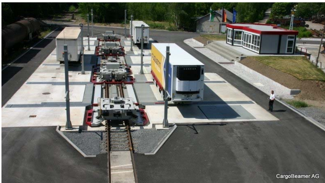
Slika 19. Prikaz CargoBeamer paralelnog utovara i istovara
