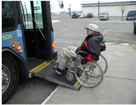
Slika 25. Ulazno/izlazna rampa autobusa
