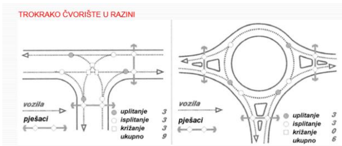
Slika 15. Konfliktna točka kod trokrakog čvorišta u razini
