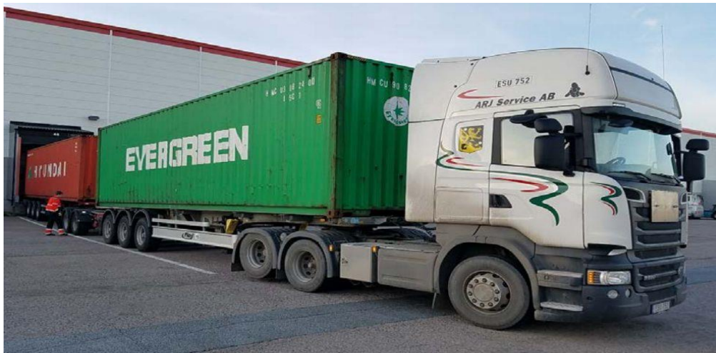
Slika 4. Tegljač za prijevoz kontejnera
