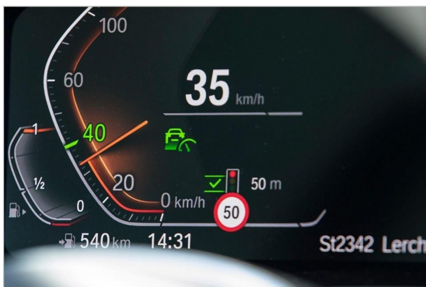
Slika 18. Prikaz TSR-a s prilagodljivim tempomatom, [27]
