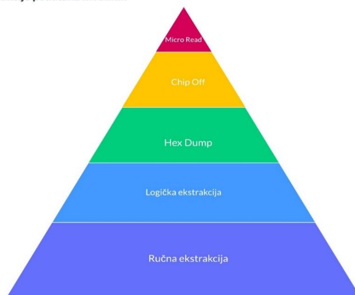
Slika 10. Metode ekstrakcije podataka mobilnih uređaja, [28]
