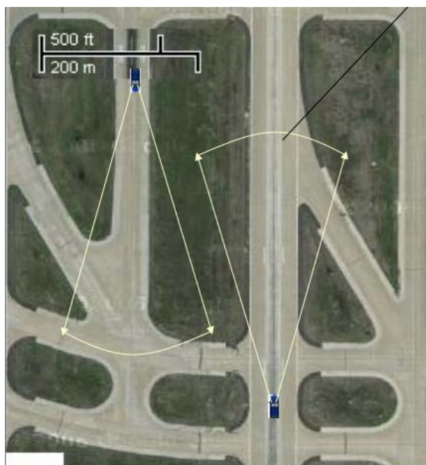
Slika 11. Polje skeniranja mobilnih radarskih sustava, [11]
