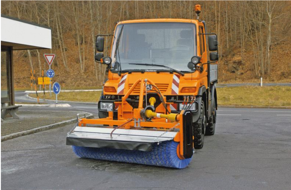
Slika 21: Stroj za čišćenje nečistoća sa prometnica
