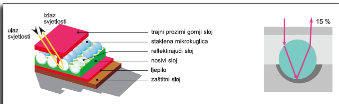
Slika 4. Materijal Klase II – High Intensity Grade Izvor:[6]
