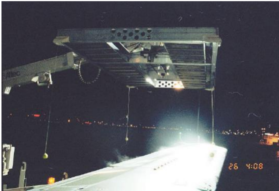
Slika 21. Infracrveni panel postavljen iznad krila Izvor: [23]
