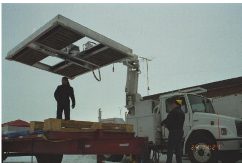
Slika 20. Mobilni infracrveni sustav - ICE CAT Izvor: [23]
