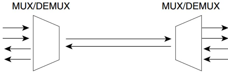
**Slika 4.15. Multipleksiranje i demultipleksiranje u dvosmjernom sustavu, [24]**
