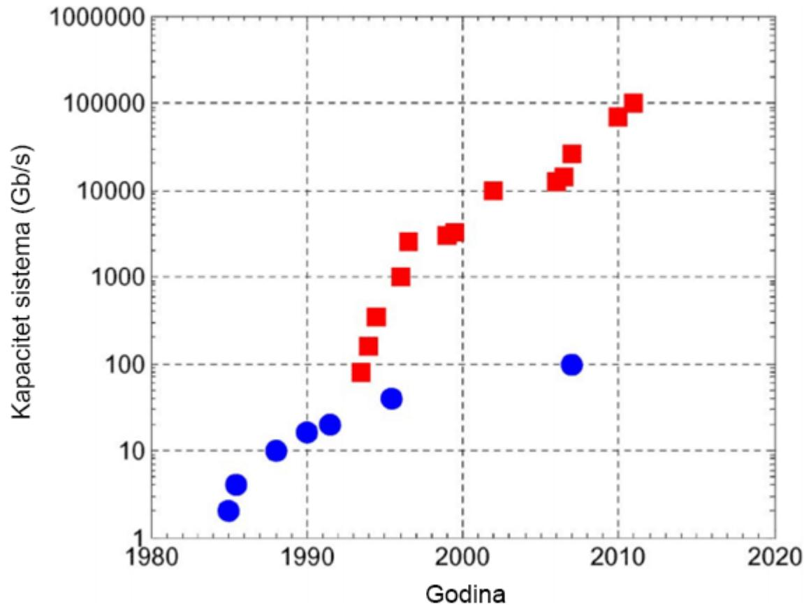
Slika 2.7. Usporedba kapaciteta za TDM i WDM, [5]
