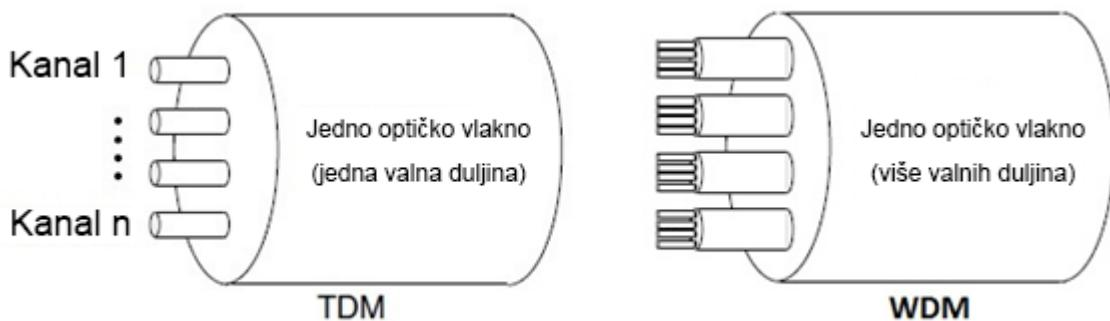
Slika 2.5. Usporedba iskorištenja kapaciteta za TDM i WDM, [3]
