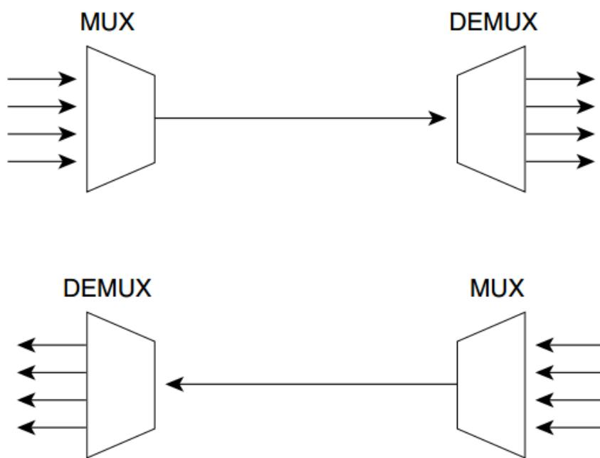
Slika 4.14. Multipleksiranje i demultipleksiranje u jednosmjernom sustavu, [24]
