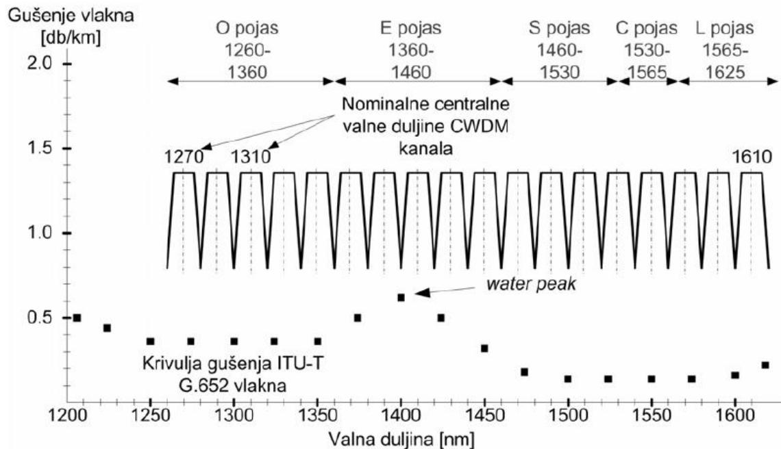
Slika 3.1. CWDM kanali u odnosu na optičke pojaseve, [18]
