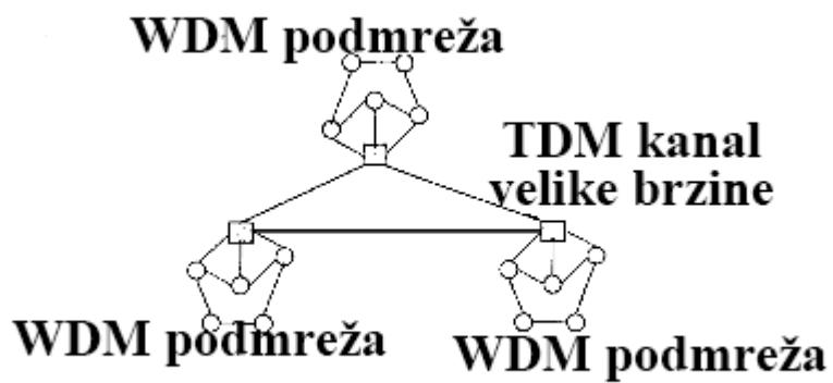
**Slika 2.8. Primjer TDM/WDM optičke prijenosne mreže, [1]**
