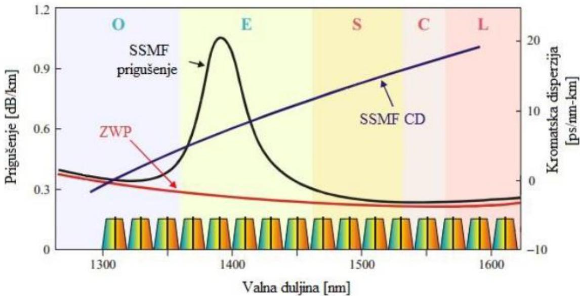
Slika 4.6. Atenuacijska i disperzijska krivulja jednomodnog optičkog vlakna, [13]
