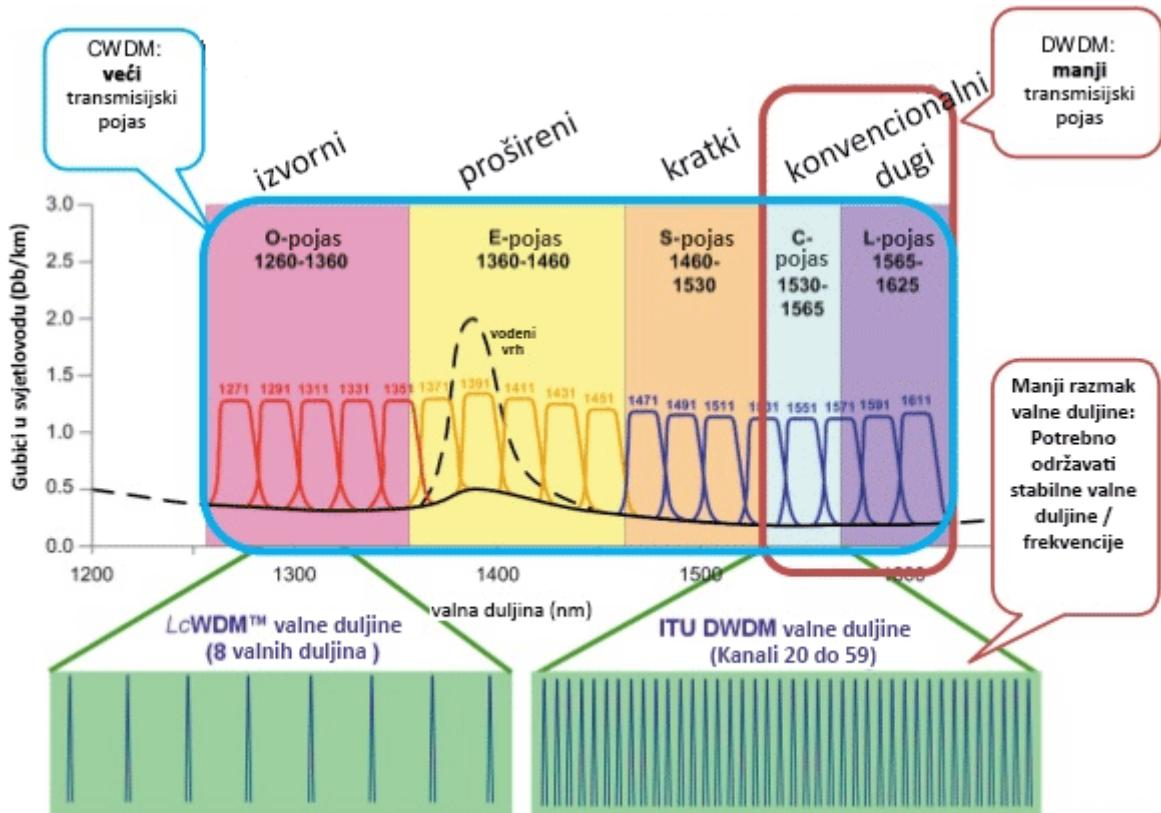
Slika 3.4. DWDM kanali u odnosu na optičke pojaseve, [21]
