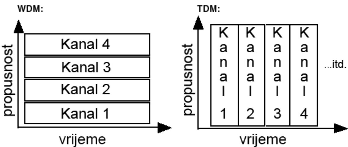
Slika 2.3. Usporedni prikaz WDM i TDM principa multipleksiranja, [2]
