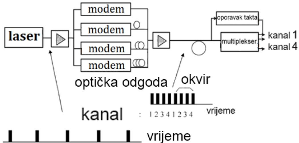
Slika 2.2. Princip rada TDM-a, [1]
