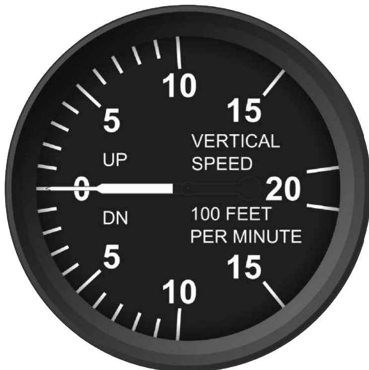
Slika 23. Izgled prikaznika standardnog variometra
