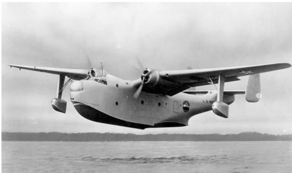
Slika 4. Hidrozrakoplov sa trupom kao centralnim plovkom [6]
