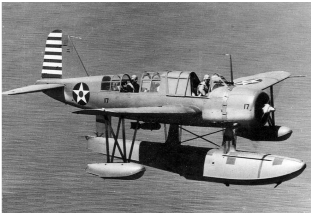
Slika 3. Hidrozrakoplov sa centralnim plovkom [5]
