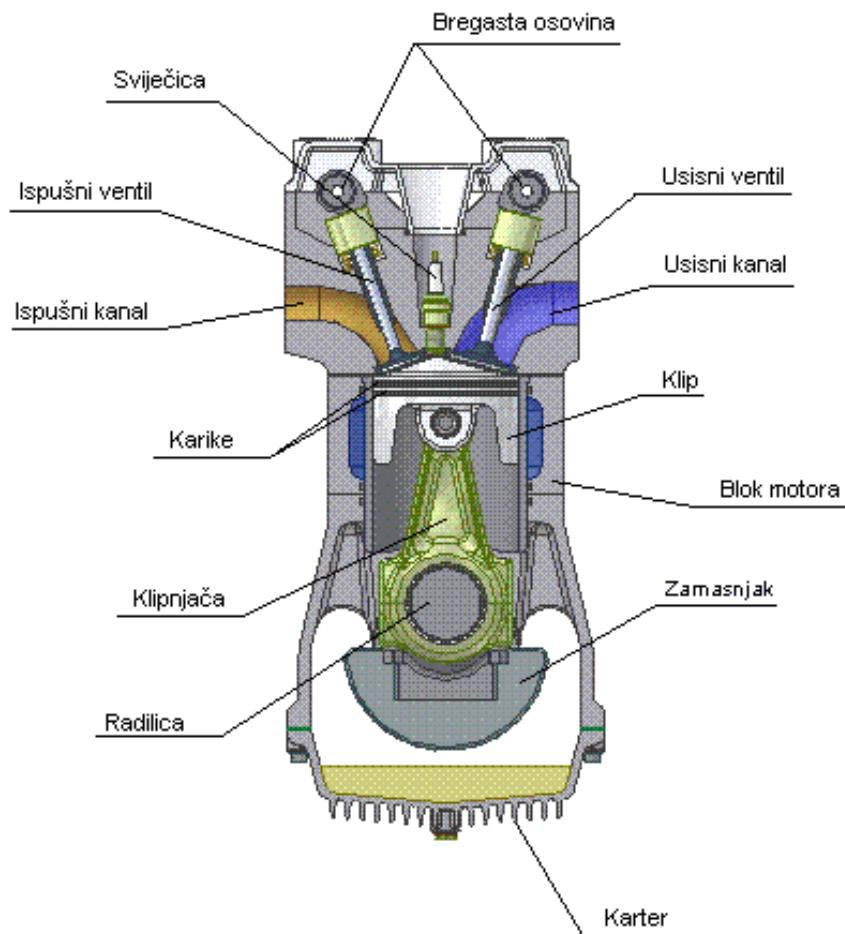
**Slika 4.** Četverotaktni motor [8]
