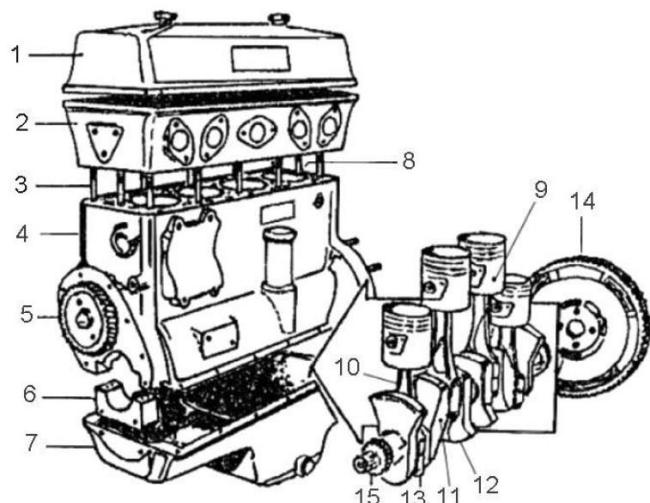
Slika 5. Glavni dijelovi motora s unutarnjim izgaranjem [4]
