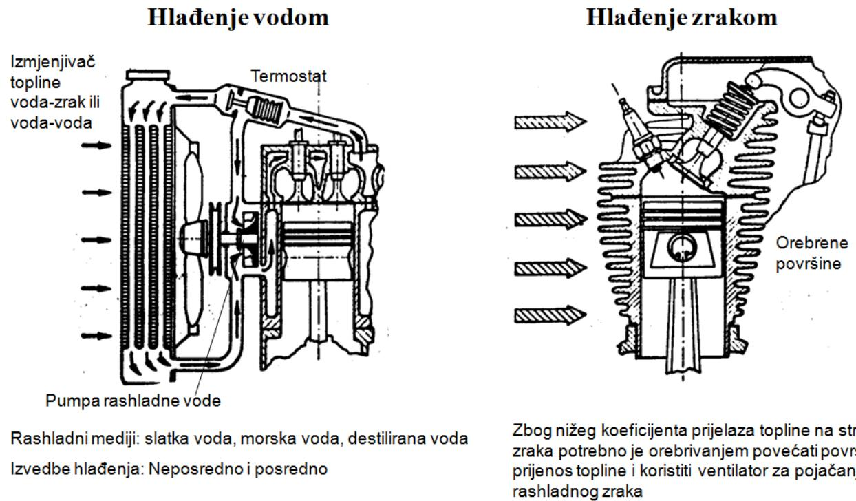
**Slika 21.** Usporedni prikaz sustava za hlađenje motora zrakom i tekućinom [16]
