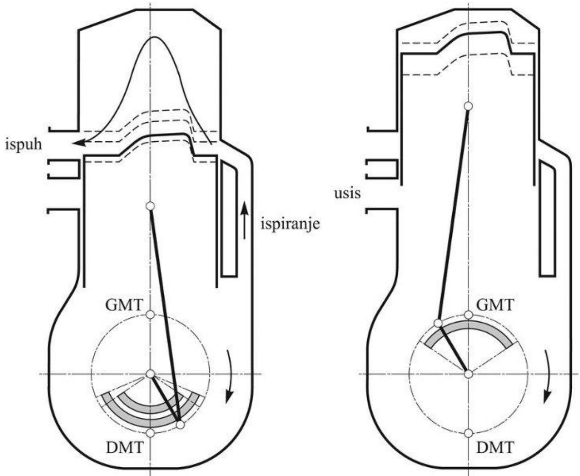
**Slika 3.** Dvotaktni motor [8]
