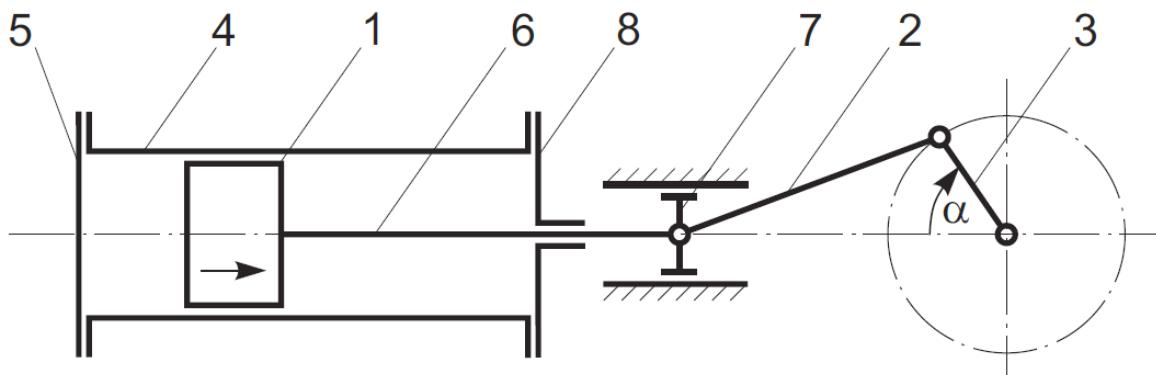
Slika 1. Skica motornog mehanizma sa križnom glavom [3]
