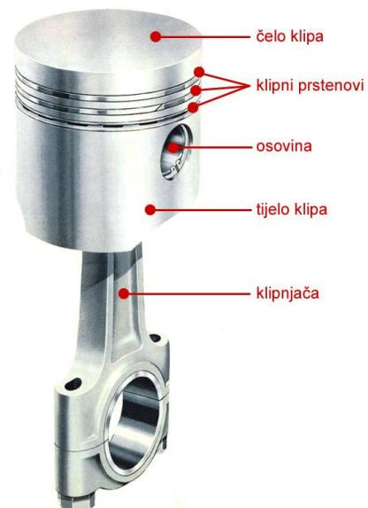
Slika 7. Klipnjača motora [4]
