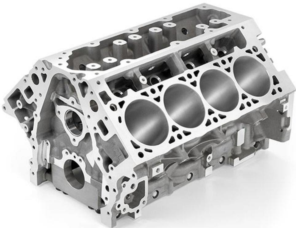
**Slika 8.** Blok motora [8]
