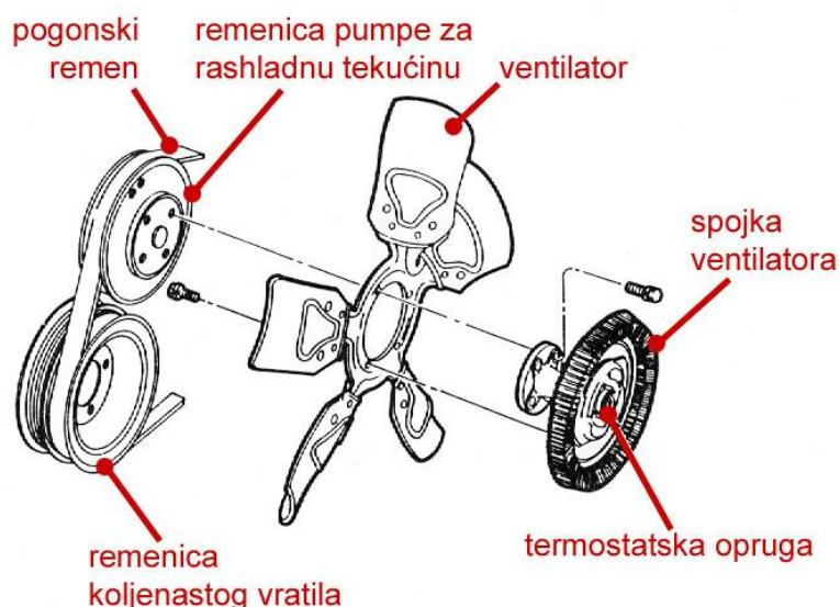
**Slika 20.** Ventilator promjenjive brzine rada opremljen termostatskom spojkom [8]
