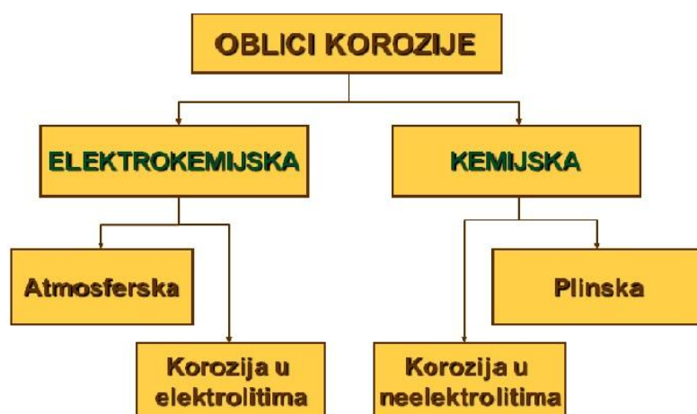
Slika 3.3. Shematski prikaz oblika korozije, [3]
