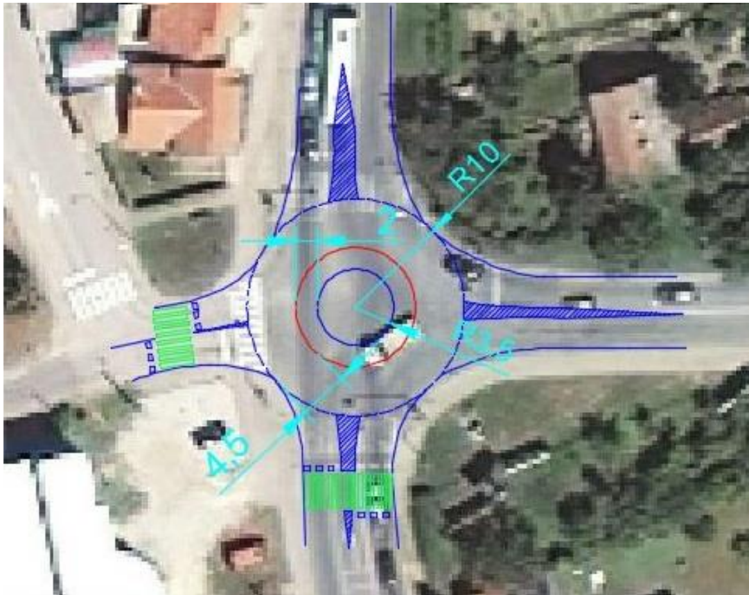
Slika 33. Prijedlog rješenja kružnog raskrižja
