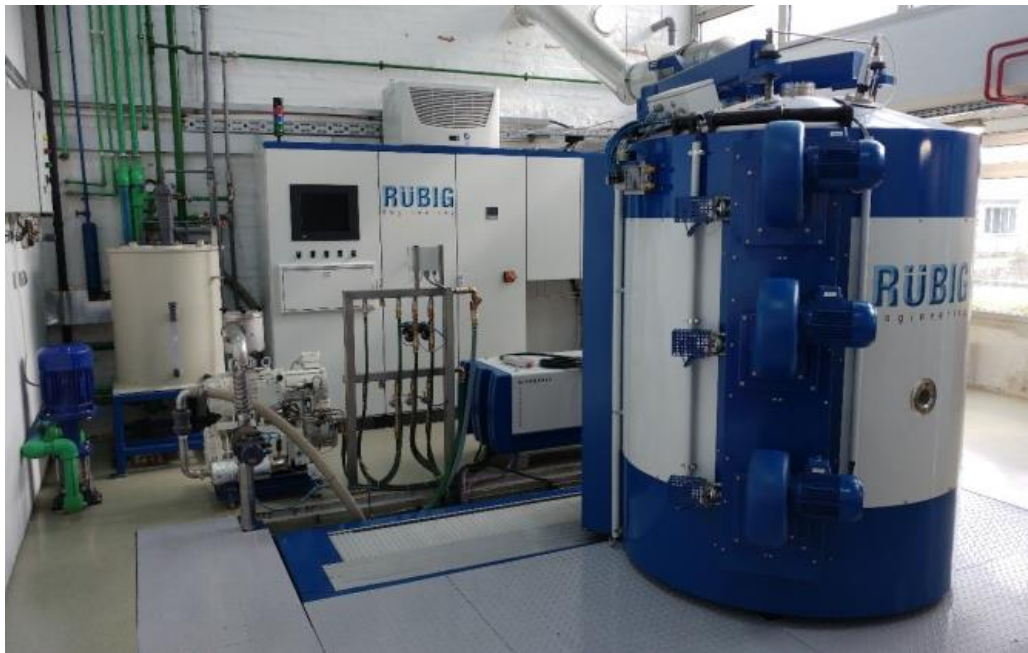
Slika 22. Vakuumska peć za nitriranje u plazmi Rübigo PN 70/90
