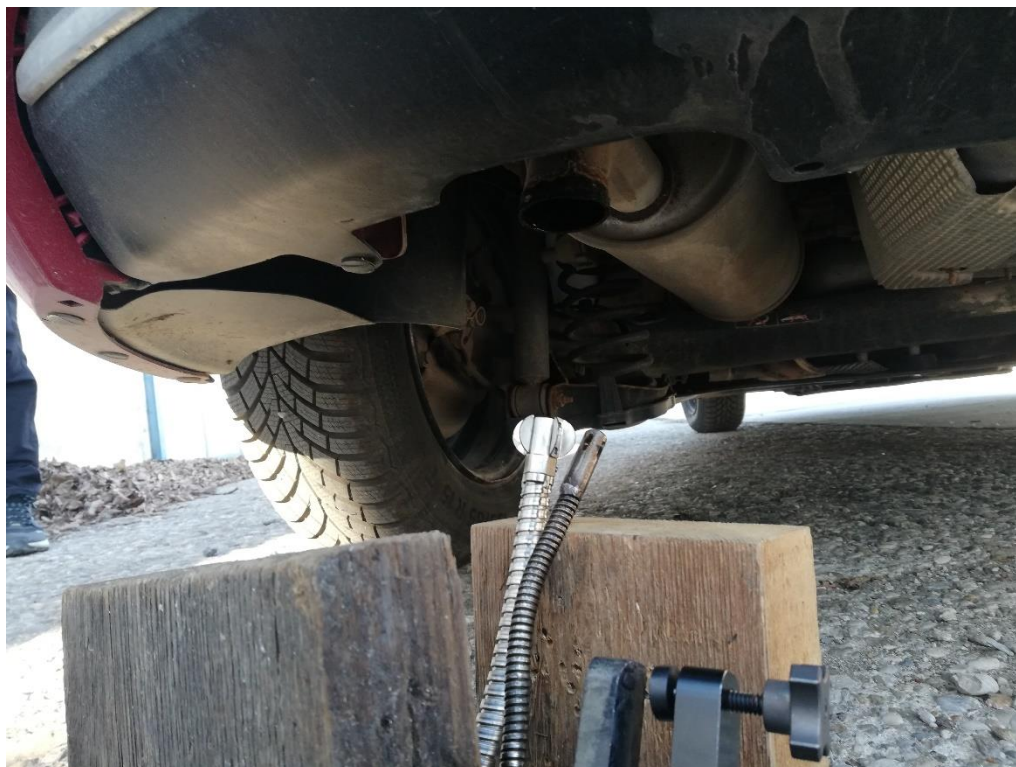
Slika 5.5. Senzor mjernog uređaja udaljen od ispušne cijevi za trideset centimetara
