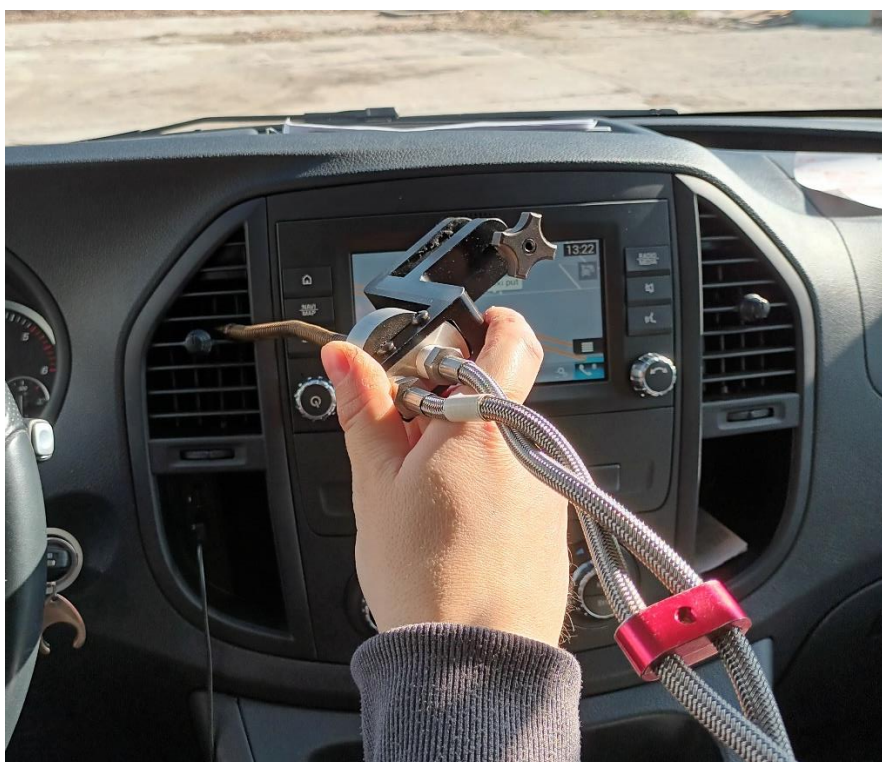
Slika 5.3. Mjerenje kad je sonda postavljena na otvor ventilacije
