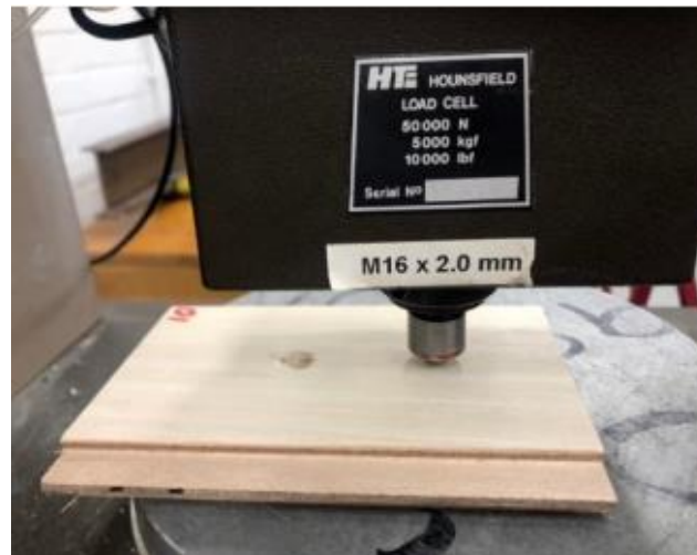
Slika 21. Ispitivanje tvrdoće drva metodom po Janki [21]
