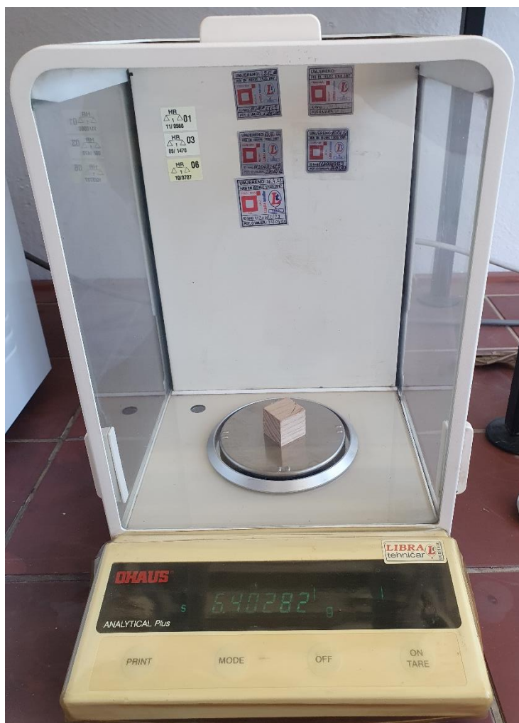
Slika 29. Mjerenje uzorka na analitičkoj vagi
