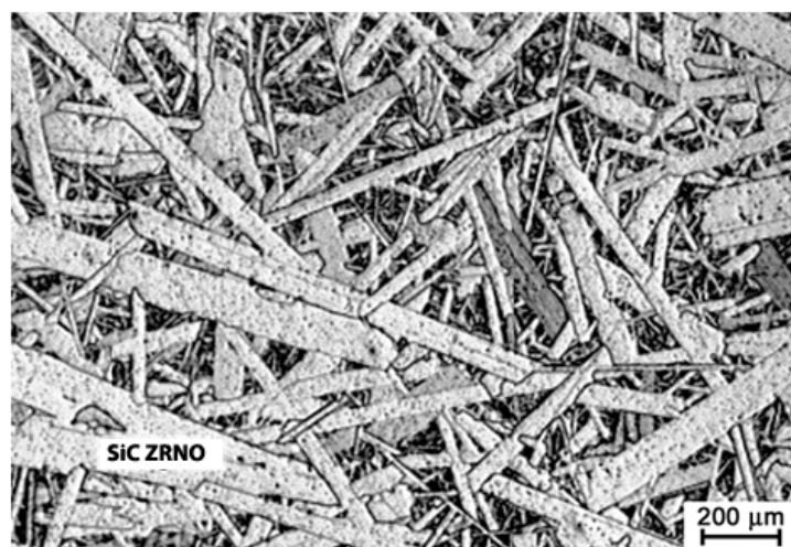
Slika 5. Mikrostruktura grubozrnatog SSIC [2]
