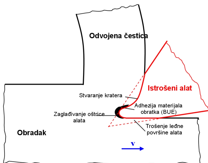
Slika 2.9. Trošenje alata [4]
