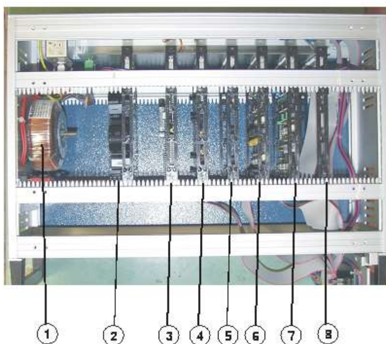
Slika 24. Elektro-kontakt PLC-12 (pogled odozgo)
