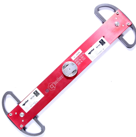
Slika 6. Poluga za umjeravanje marke Norbar [3]
