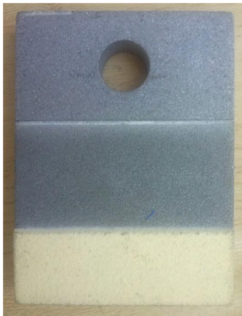
Slika 22. Dobiveni uzorak TBC prevlake APS postupkom naštrcavanja
