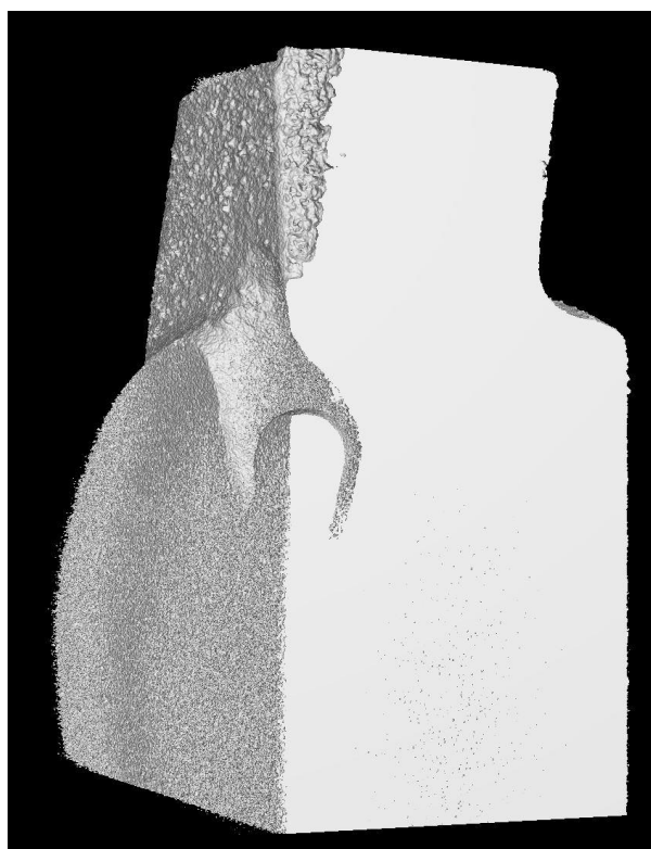
Slika 64. Usahlina u presjeku
