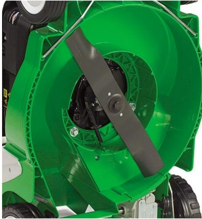
Slika 8. Bubanj kosilice sa rotirajućim nožem, [7]
