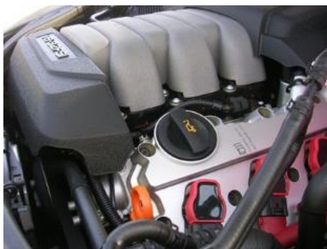
Slika 4.12. Poklopac glave motora kod 3,2 FSI motora [90]
