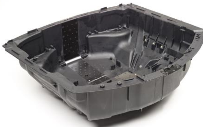
Slika 2.13. Poliamid ojačan staklenim vlaknima, korito za rezervni kotač, Audi A8 [43]
