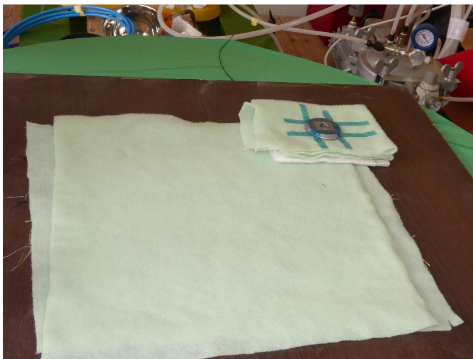
Slika 7.9. Postavljanje tkanine za upijanje viška smole i ventila
