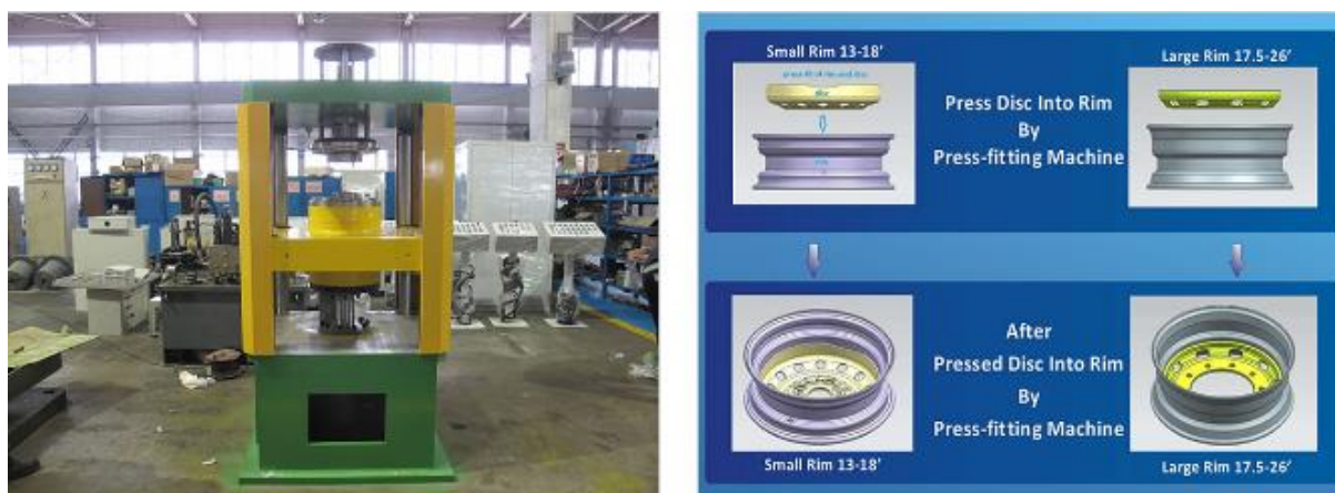
Slika 4.9 Pritisak diska u naplatak, zavarivanje [17]
