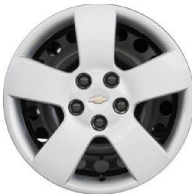
Slika 3.5 Poklopac naplatka od Chevroleta pričvršćenog vijcima [16]
