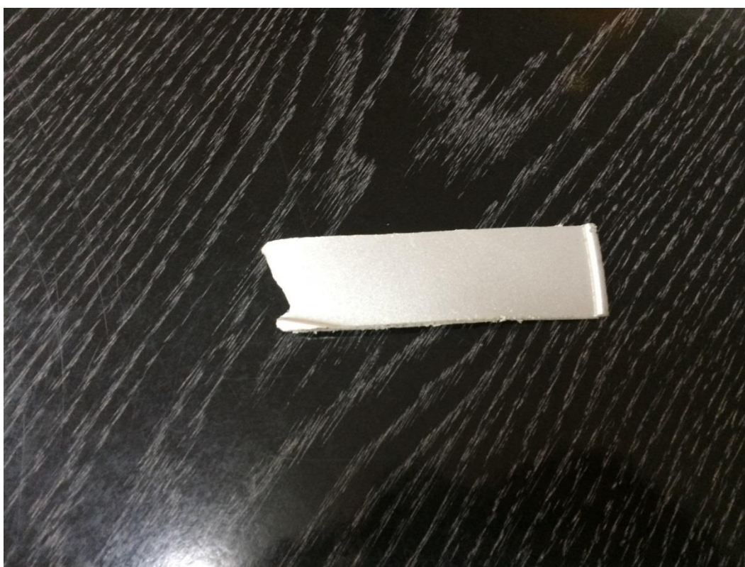
Slika 7.15 Polimerni dio za mjerenje otpornosti na abrazijsko trošenje
