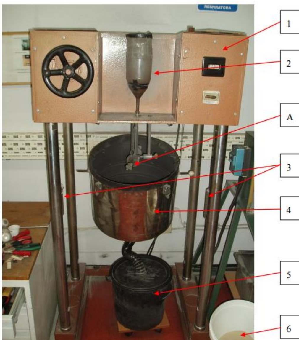
Slika 7.4 Uređaj za ispitivanje otpornosti na erozijsko trošenje [30]
