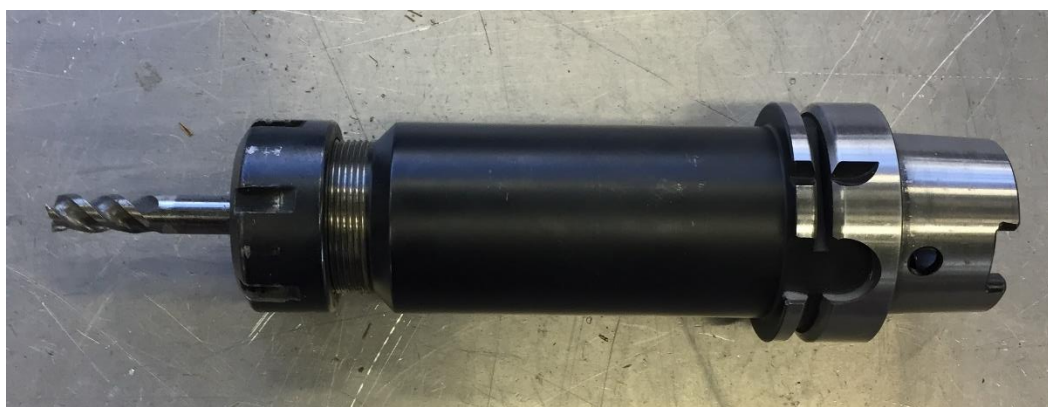
Slika 44. Ravno glodalo \Phi 10 u držaču alata HSK 63
