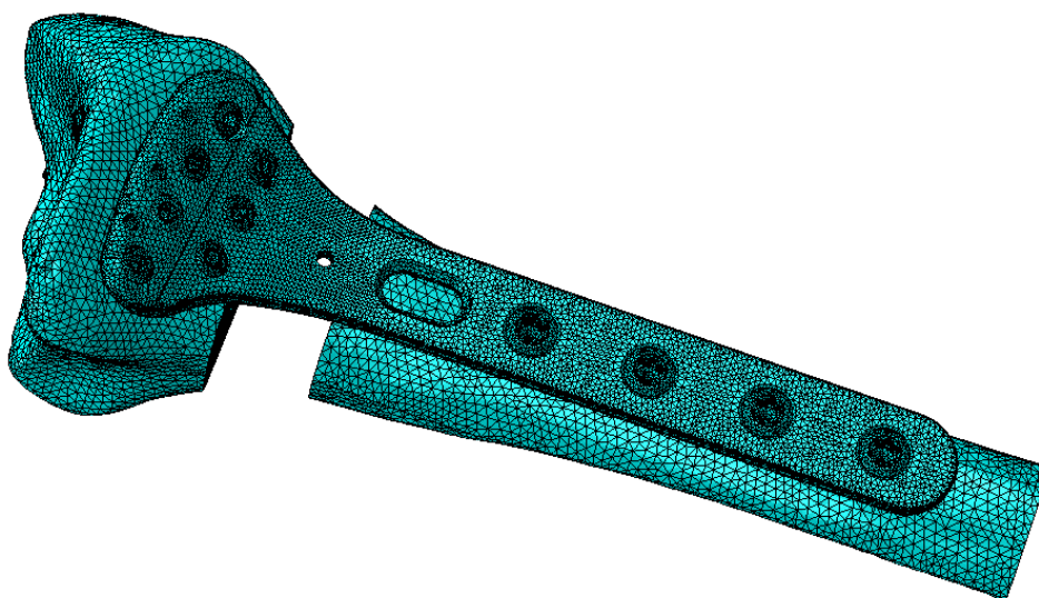
Slika 18 Mreža konačnih elemenata na modelu s kratkom pločicom
