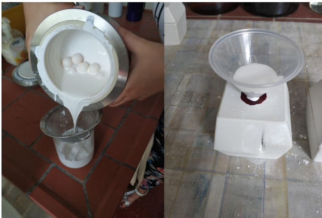
Slika 20. Odjeljivanje suspenzije od kuglica i lijevanje suspenzije u gipsani kalup
