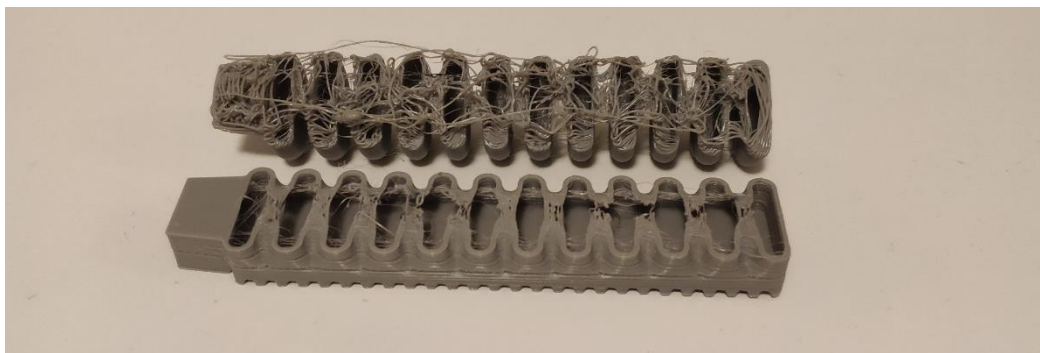
Slika 36. Greška u printanju nastala nepovezivanjem slojeva
