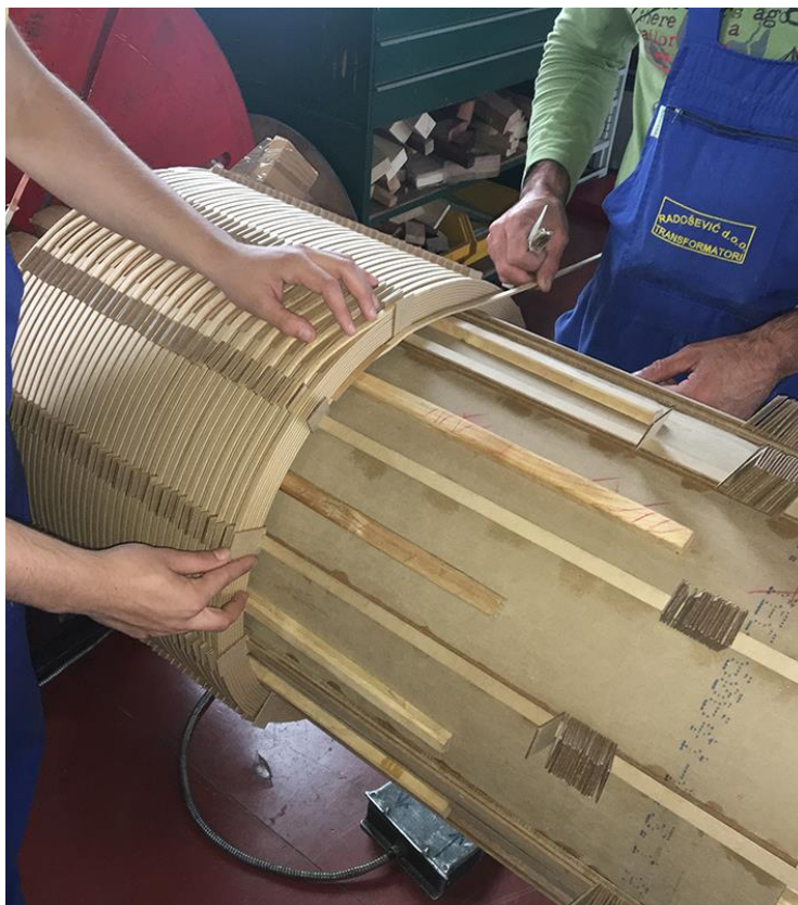
Slika 11. Izrada izolacije od papira
