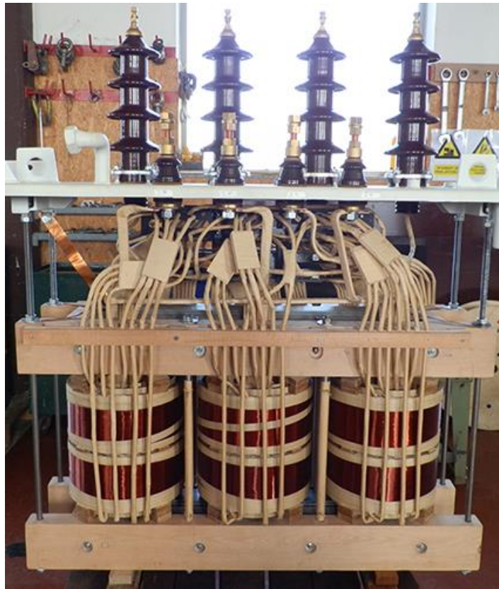
Slika 23. Izolacija trofaznog namota transformatora
