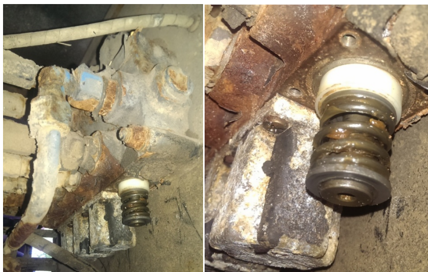
Slika 6.1 Stari razvodnici (bez elektromagneta)
