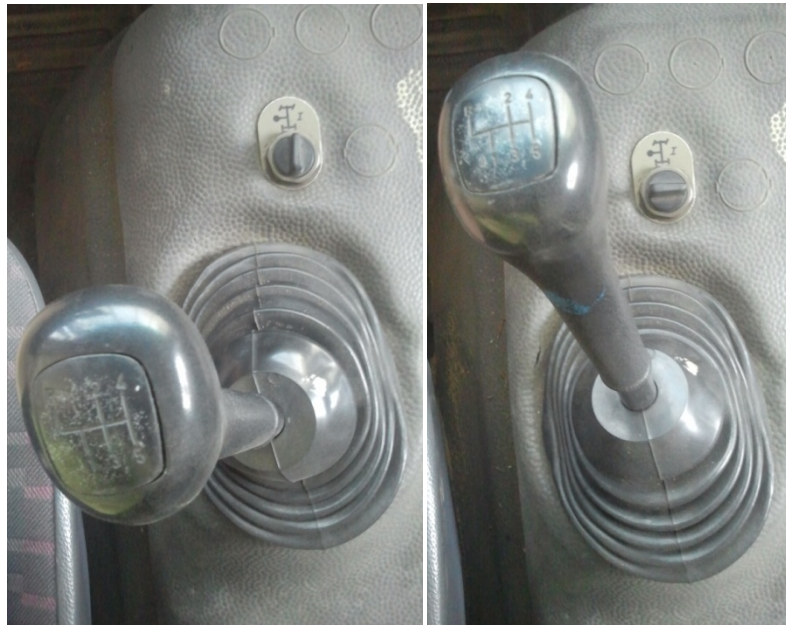
Slika 3.1 Ručica prijenosnika i oneumatska sklopka
