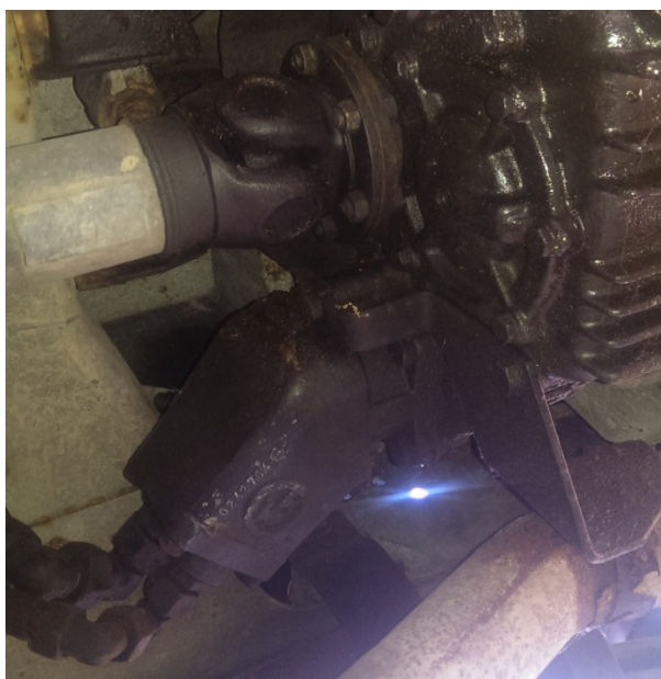
Slika 4.3 Prikaz integrirane aksijalno klipne pumpe s prijenosnikom MSUI
