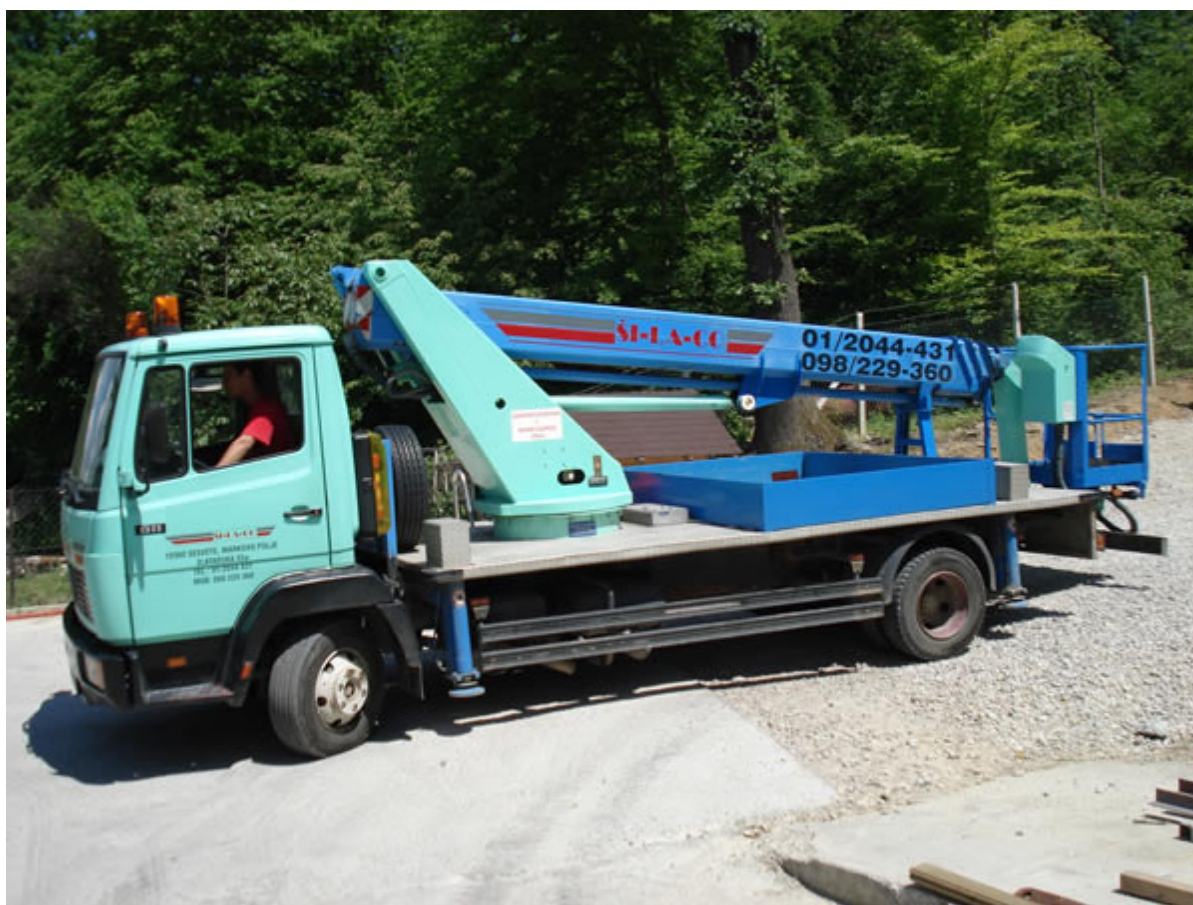
Slika 1.1 Kamion Mercedes-Benz 811 i dizalica Wumag WT 225
