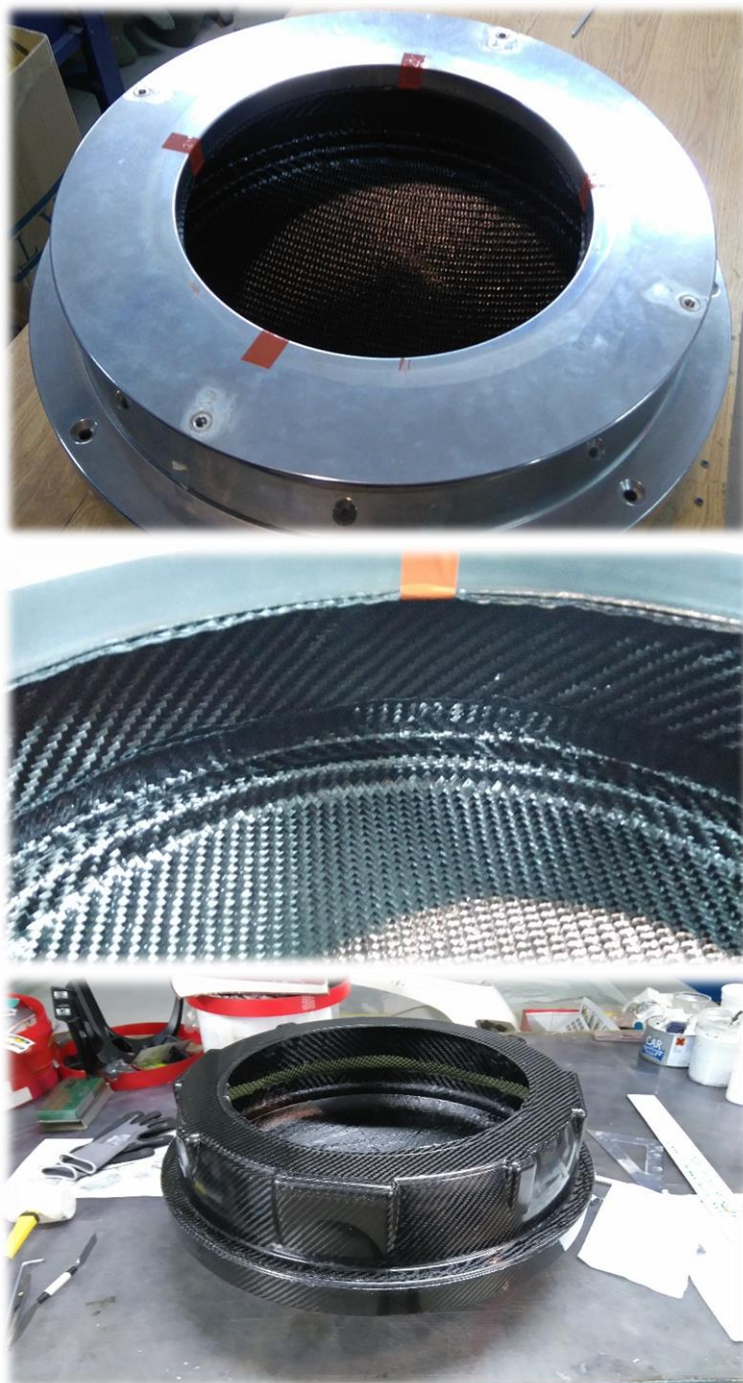
Slika 4.13 Slaganje krojeva u kalup te dobivanje otpreska autoklav tehnologijom
