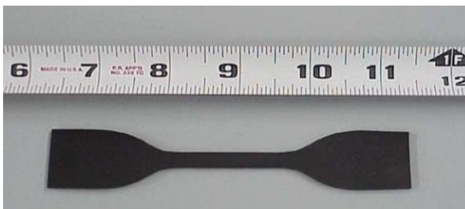
Slika 4. Epruveta od elastomera (gume) [3]
