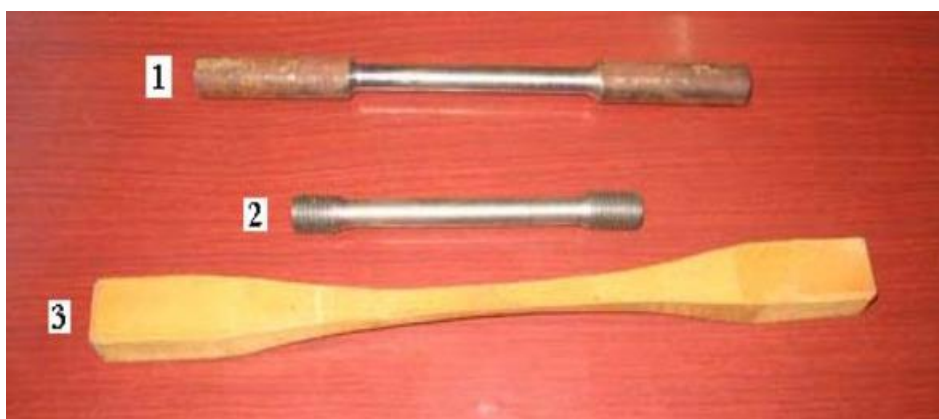
Slika 6. Epruvete od čelika (1), nodularnog ljeva (2), drva (3) [3]
