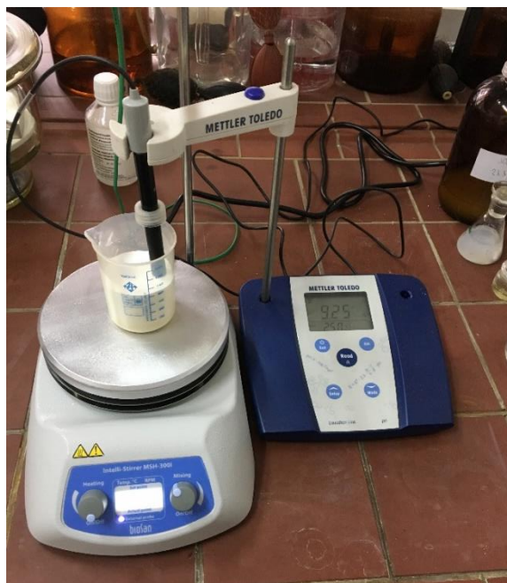
Slika 21. Mjerenje pH vrijednosti suspenzije
