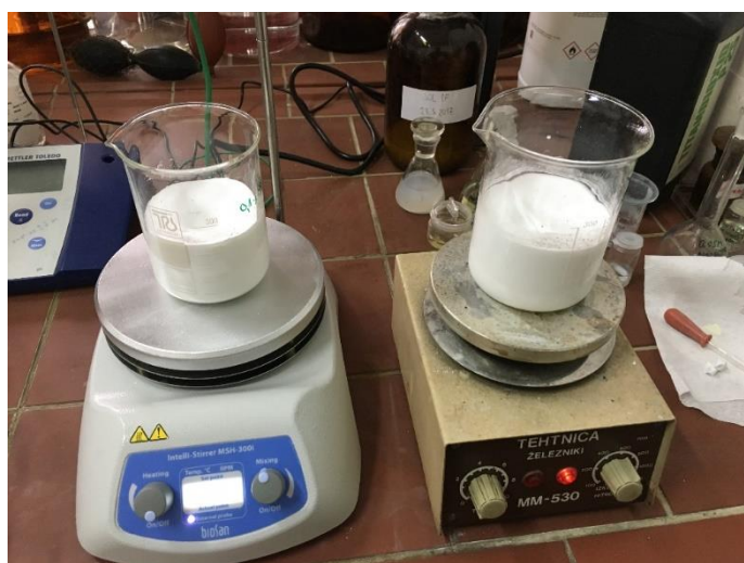
Slika 20. Miješanje suspenzija na magnetskoj miješalici
