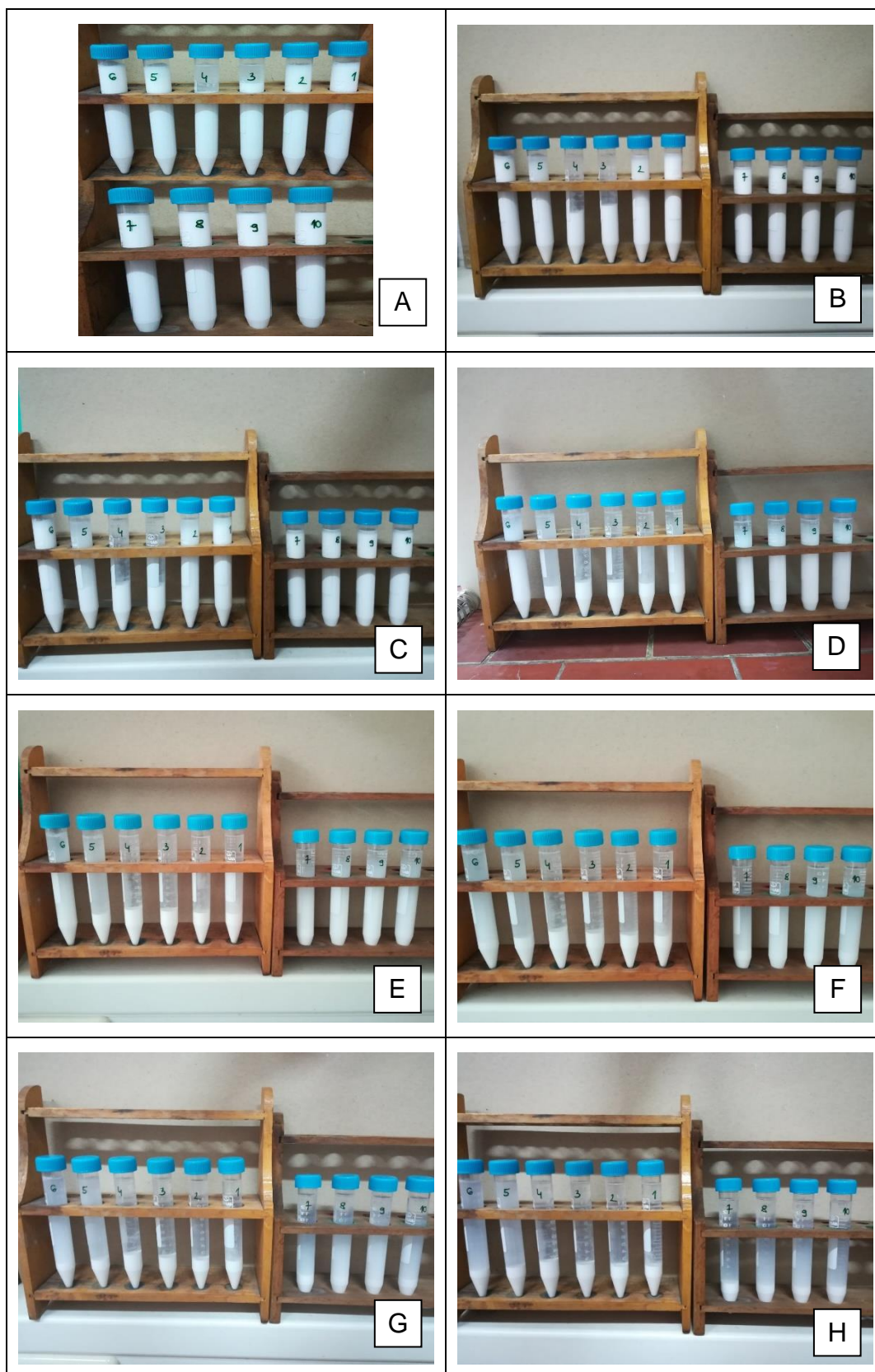
Slika 24. Graduirane epruvete u kojima je 20 %-tna Al_2O_3 vodena suspenzija stabilizirana s 0,1 % limunske kiseline nakon (A) 15 minuta, (B) 1 sat, (C) 2 sata, (D) 24 sata, (E) 48 sati, (F) 72 sata, (G) 96 sati i (H) 168 sati sedimentacije.
