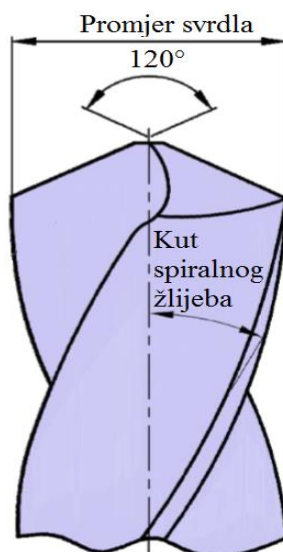
Slika 3. Geometrija spiralnog svrdla [5]
