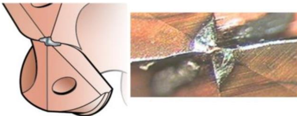
Slika 15. Trošenje stražnje površine poprečne oštrice [12]
