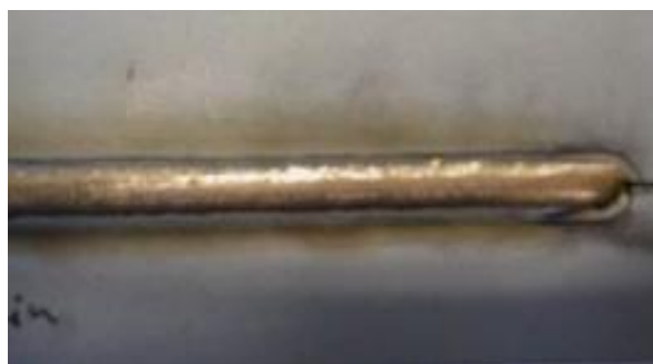
Slika 12 CMT lemljenje pocinčanog lima, 1mm debljine. Brzina lemljenja 1,5m/min [1]
