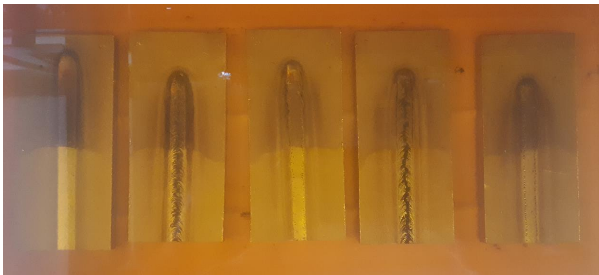
Slika 33. Pripremljeni uzorci uronjeni u desetpostotnu otopinu željezovog (III) kloridheksahidrata
