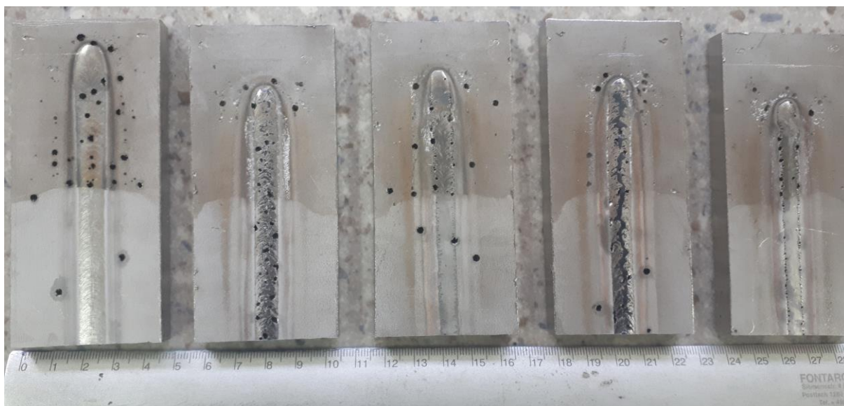
Slika 40. Izgled očišćenih površina uzoraka nakon 48 h u otopini
